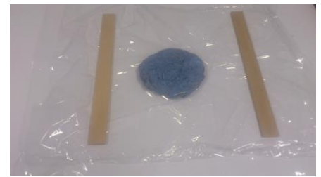
Abb. 4 : Die Knetmasse zwischen zwei Schichten Folie. Links und rechts jeweils eine 3 mm dicke Leiste.
