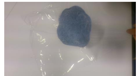
Abb. 6 : Die obere Folie wurde entfernt, und das Epoxy wird mit Hilfe der unteren Folienschicht angehoben.
