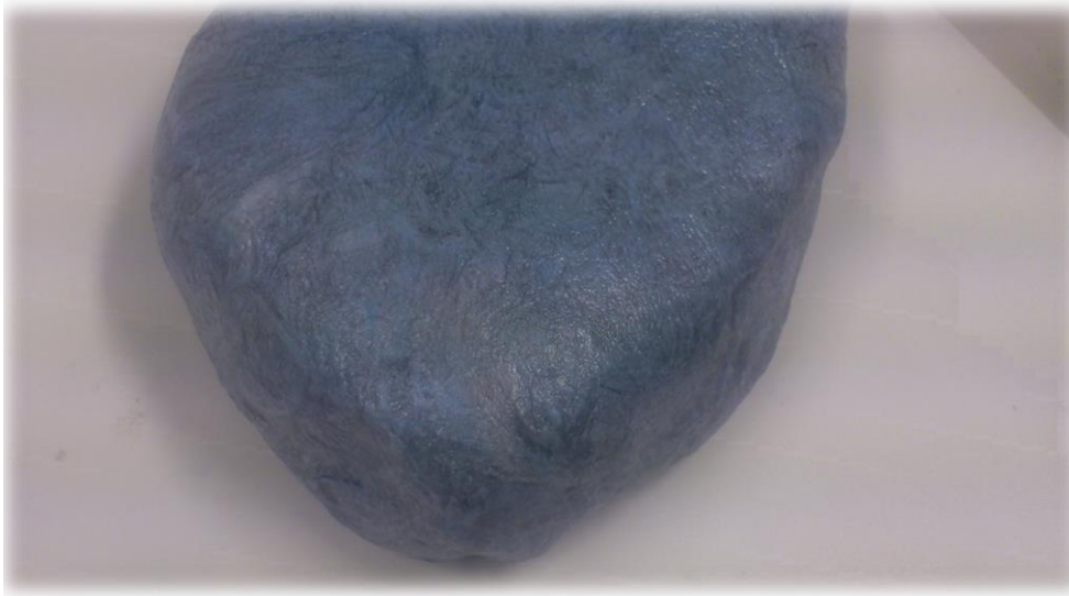
Abb. 9 : Das Urmodell, ein Silikonüberzug mit Stützform aus Epoxy.
