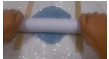
Abb. 5 : Mit einer Rolle oder einem Nudelholz wird die Masse auf 3 mm Stärke ausgerollt.
