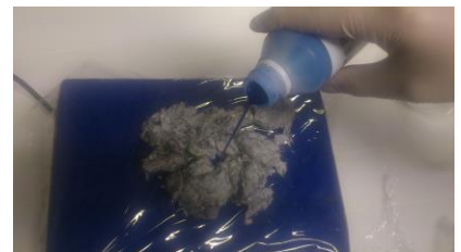
Abb. 2 : B-Komponente (16 Gramm) wird über die A-Komponente gegossen.
