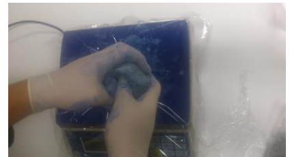
Abb. 3 : Kneten Sie die Komponenten zu einer homogenen Masse. Es wird empfohlen dabei Handschuhe zu tragen.
