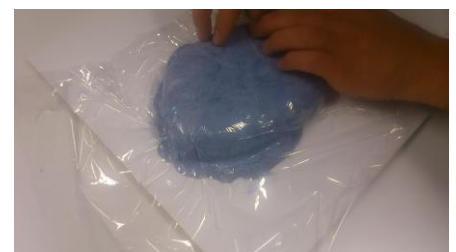
Abb. 7 : Das Epoxy wird über das Silikonmodell gelegt und angedrückt.
